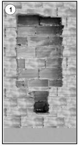
Predisporre il vano nella parete per Hidrofix sulla base delle misure di ingombro e della quota d'installazione del WC.
