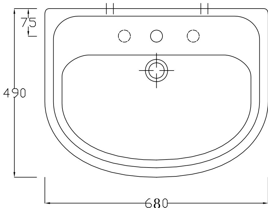
N.B. Le misure indicate possono subire una variazione dell'0,6% circa, dovuta ad usura stampi e a variazioni delle caratteristiche tecniche relative alle materie prime che compongono l'impasto.
