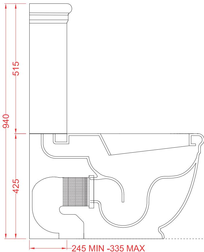
N.B. Le misure indicate possono subire una variazione dell 0,6% circa, dovuta ad usura stampi e a variazioni delle caratteristiche tecniche relative alle materie prime che compongono l'impasto .
